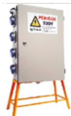
Painel para Máq. de Solda IP55 32 A 3P + T / 380/440V 6 Tomadas IP 44
