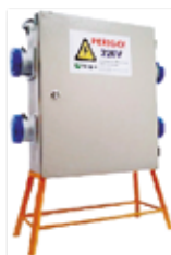
Transformador /isolador IP55 De 30 e 50 KVA Entrada: 440/380V saída: 220V
